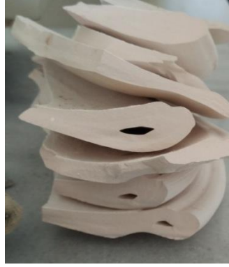
Görsel 5: İçinde hava kalmış, bisküvi pişirimi sonrasında fiziki darbe ile kırılmış pişmiş toprak tabak; içinde hava boşluğu kalarak kullanım sırasında fiziki kırılmalar nedeni ile karşılaşılan sırlı örnekler ile de görselleri çoğaltmak mümkündür.
