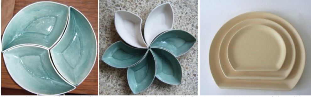
Görsel 25: El şablonu tekniği ile yazar tarafından üretilmiş olan soldaki iki görsel, boş döküm örneğinin iki farklı sunumu (Yazar Arşivi), sağdaki dolu döküm örneği (Pala 2010)
