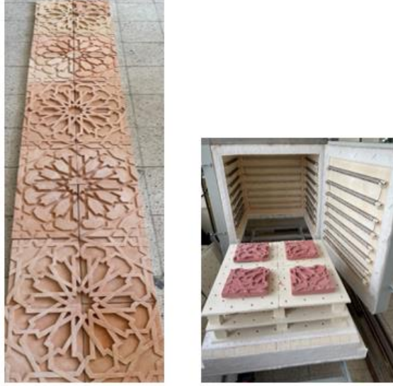
Resim 8 “Seramik Pano Bisküvi (solda), Sırlı Fırınlama (sağda) ”
