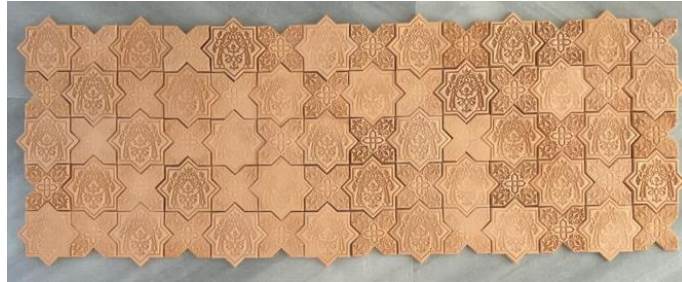
Resim 2 “Mühür Dekor Uygulama Bisküvi”
